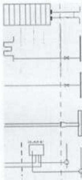
Отопление - до контргайки отопительного прибора в помещении, при имеющейся перемычке или до установленной запорно-регулирующей арматуры - перед отопительным прибором.
